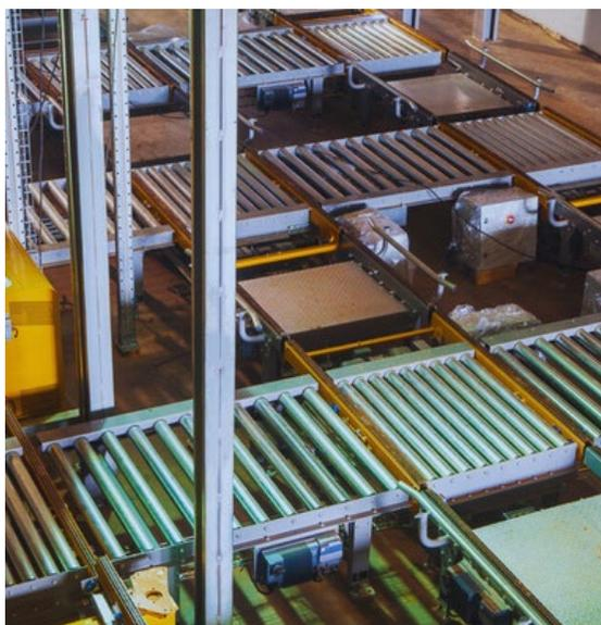
O Sistema Satélite é um modelo automático de armazenagem, totalmente controlado por software.
