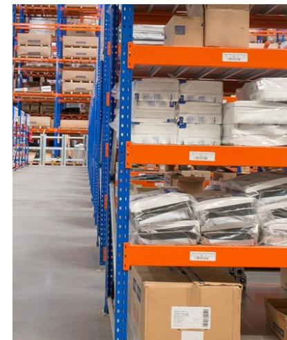
A estrutura Mini Porta Pallet é desenvolvida especialmente para operações em sistemas de picking manual, não sendo necessário o uso de empilhadeiras.
